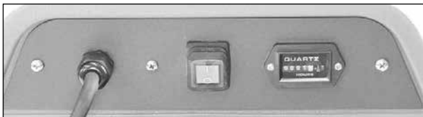
Le compteur d'heures de service permet de lire les heures de service écoulées.
